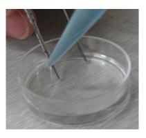
用移液器将培养皿中的废液吸出,加入 5~10 ml 新鲜测试液,静置 15~30 分钟后上样检测。
