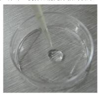
用移液器吸取一定量测试液,沿培养皿边缘缓慢加入,同时用镊子轻轻压住玻片边缘,防止玻片漂浮,测试液需没过粘附玻片。
